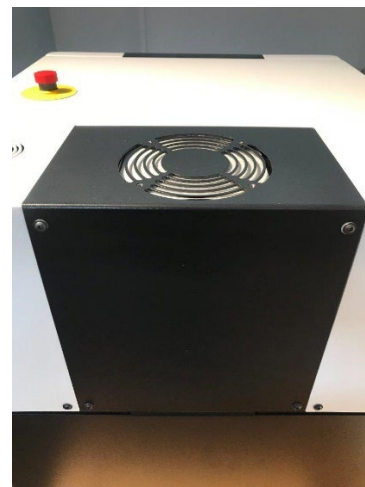
Lüfter Abluft oben
